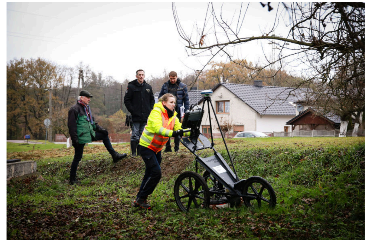
Das Bodenradar im Einsatz in Toszek, Foto: UOKG 2024
